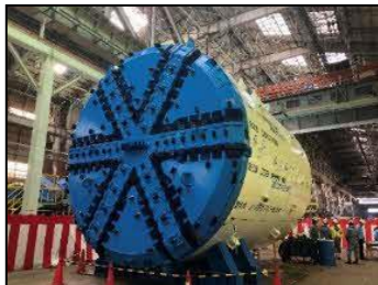
シールドマシン全景 (シールド機外径φ5,900mm)
