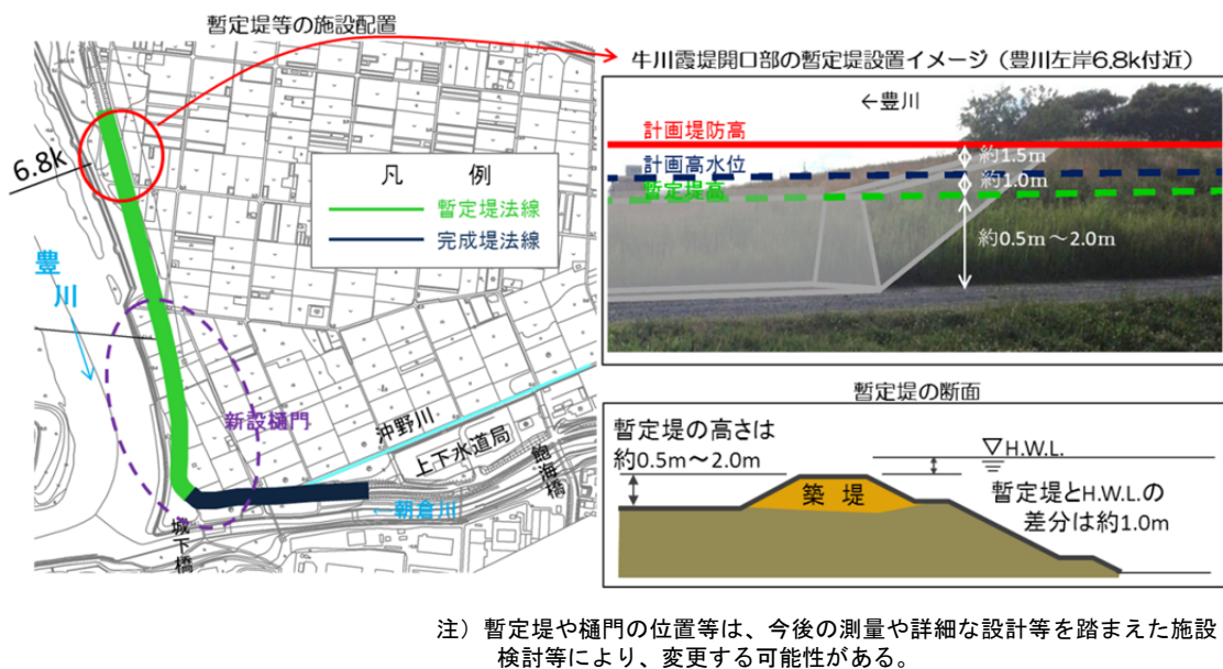
図 3-22 暫定堤設置イメージ【牛川霞堤地区】
