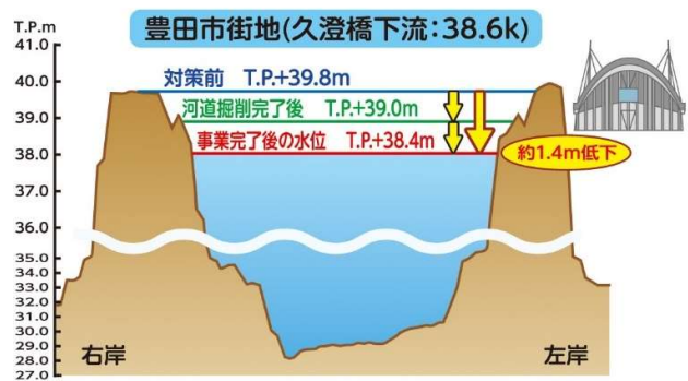
対策による水位低下効果(横断面図)
