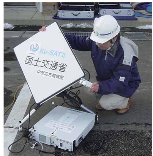
通信訓練に使われる小型画像伝送装置（Ku-Sat）
