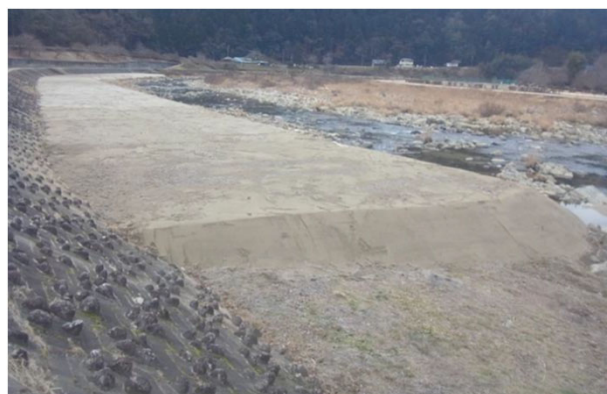
土砂供給実験(置土)の実施状況(令和4年1月)
