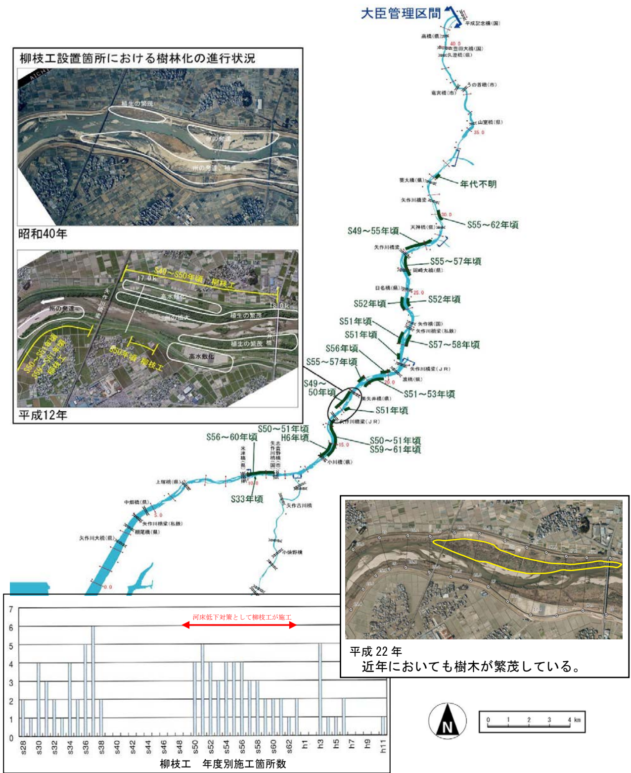
図 2.8 矢作川における柳枝工の設置状況
