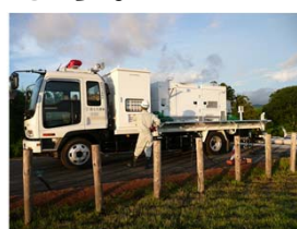
排水ポンプ車
