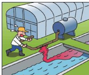
燃料用タンクの老朽化した配管等からの油漏れ
