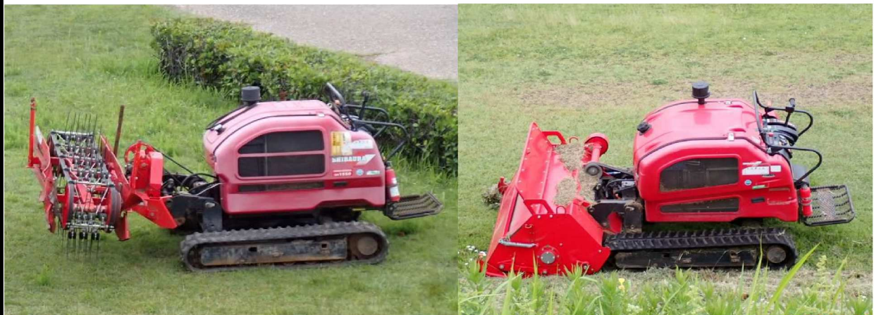
斜面を除草する機械（左）と平面を除草する機械（右） 機械の全方部分を交換しどちらにも対応できるように見える。
