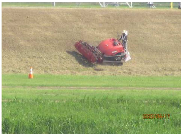
【左岸6.4km】除草後 草を集める作業【機械化】
