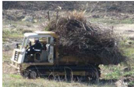
撤去樹木 輸送車 【キャタ ピラー車】
