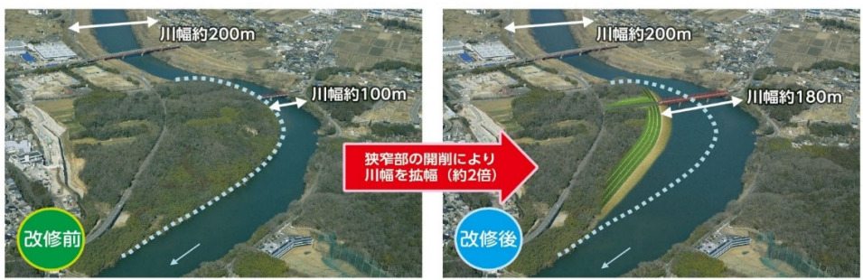
● 鶯の首地区水位低下対策事業における整備箇所・整備イメージ
