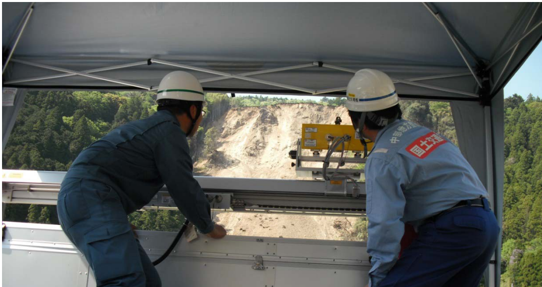
SARによる斜面の観測状況を確認する職員
