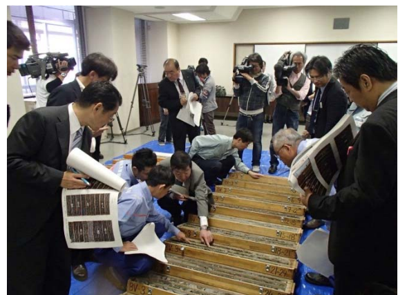
ボーリングコアを確認
