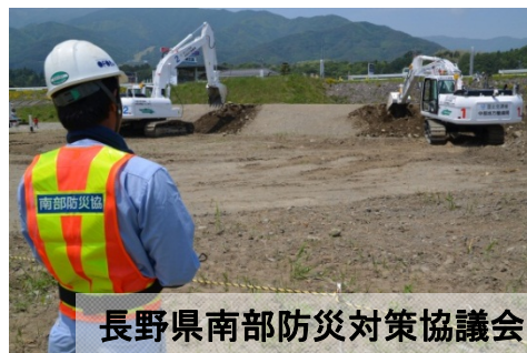
分解型・遠隔操作式重機の実技演習
