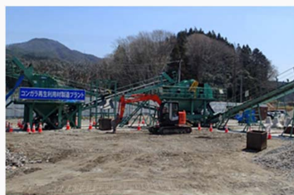
東日本大震災 約2年後 コンクリートがらの再生処理の例
