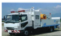
排水ポンプ車
