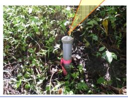
、地下水位観測の中で最も多いのが左上のオフラインと呼ぶ水位計です。この機器と左下のフロート式自記水位計は、自動観測しています。また、手動による観測も行っています。(右写真)
