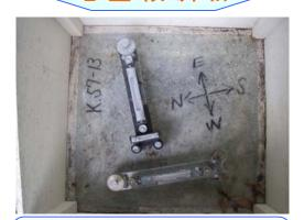
気泡管式水準計を用い、東 西・南北方向に対する地盤 の傾斜を観測します。
