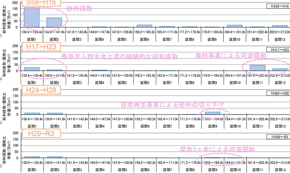
図 期間別の砂利採取量・河道掘削量縦断分布
