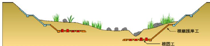
根継護岸工・根固工: 洪水時に堤防や河床を守るための、玉石張コンクリート及びコンクリートブロックによる補強。
