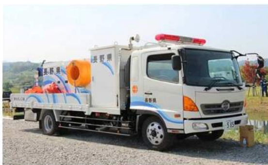
長野県排水ポンプ車
