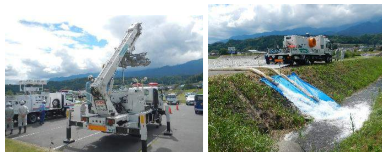
照明車・排水ポンプ車（長野ブロック操作訓練）
