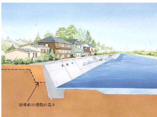
図 1-6 下久堅特定河岸地水害対策(イメージ図)
