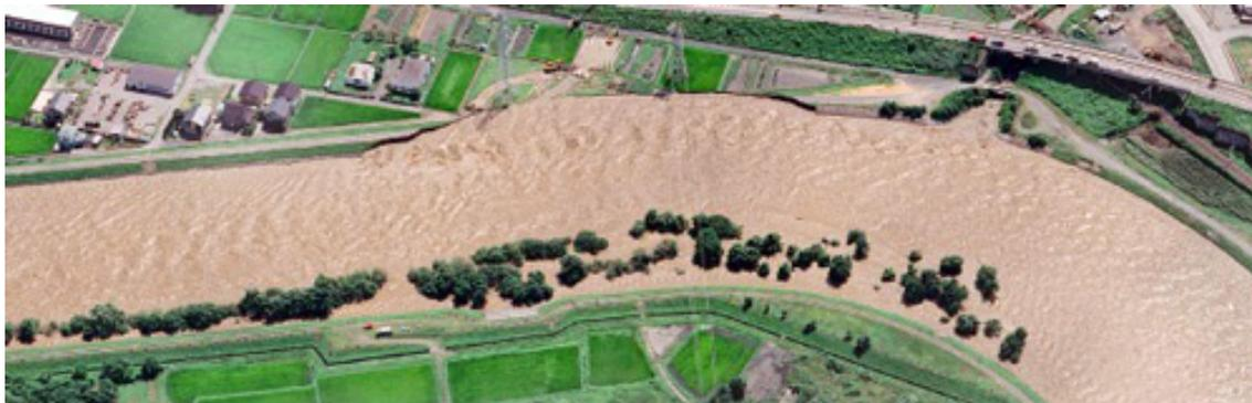
写真 1-9 天竜川本川(箕輪町松島地区)の堤防決壊箇所
