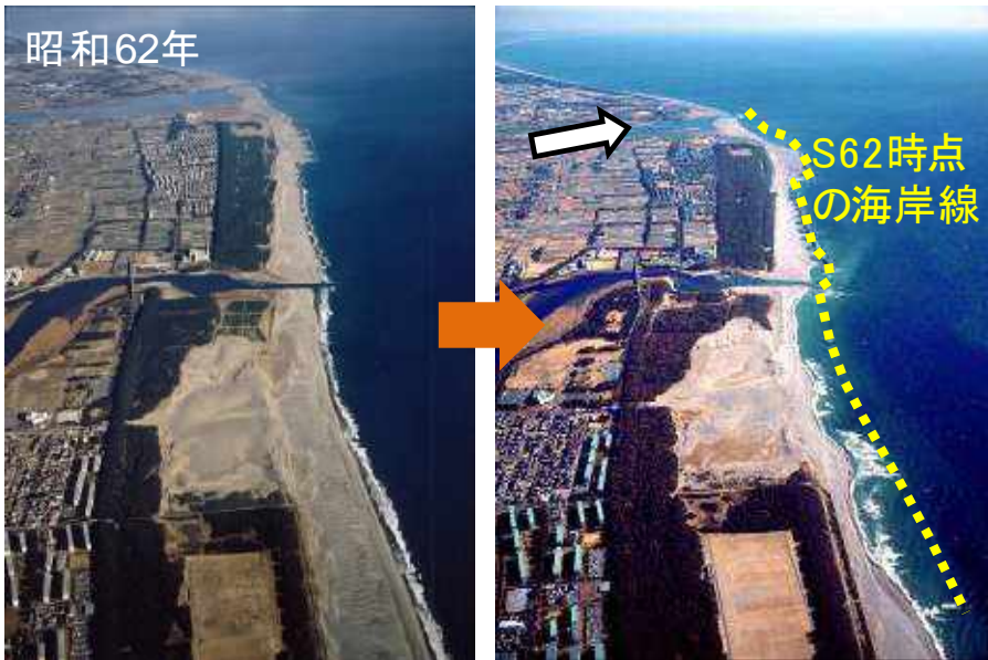
漂砂の遮断等により海岸線が後退
