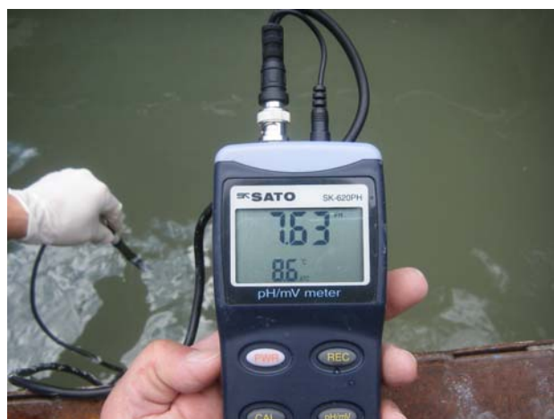
レイタンス処理水の pH 確認
