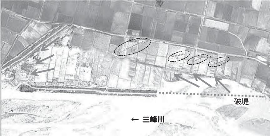
写真 9：S36 航空写真から拡散を防ぐための牛枠類
