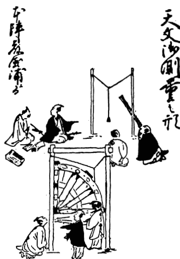
図-11 江戸時代後期(1800年頃)における伊能忠敬の天文測量の図 (『測量』1978・9より抜粋)
