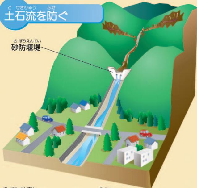
[砂防堰堤] で流れてきた土砂を受け止めます。
