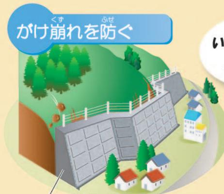
コンクリート擁壁工 斜面を擁壁で固定し、崩れや落石を防ぎます。
