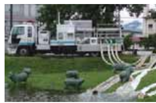
排水ポンプ車 (H18.7豪雨 諏訪市)
