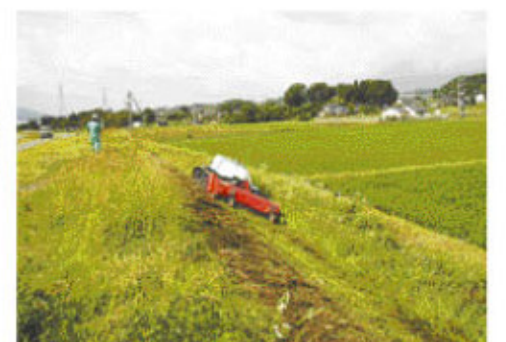
ラジコン草刈機による堤防除草
