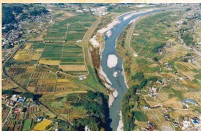
越流堤方式による治水対策
