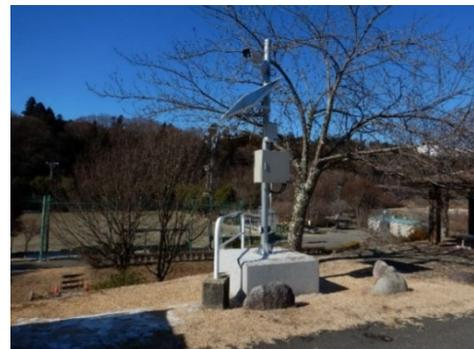
簡易型河川監視カメラの設置状況
