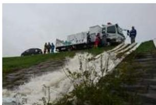
排水ポンプ車による排水作業 (R元.10長野県飯田市)
