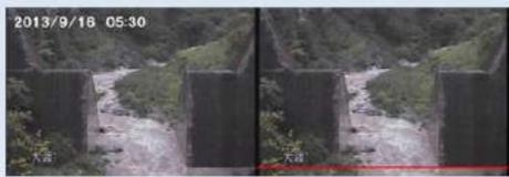
水際線の判読処理例(遠山川流域・大渡砂防堰堤)
