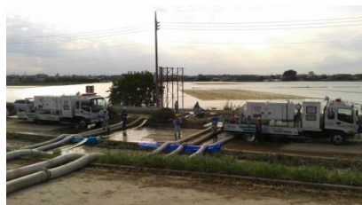
排水ポンプ車による内水排除と、照明車による排水作業支援 (H27.9 茨城県常総市(R294)ロードパーク付近)
