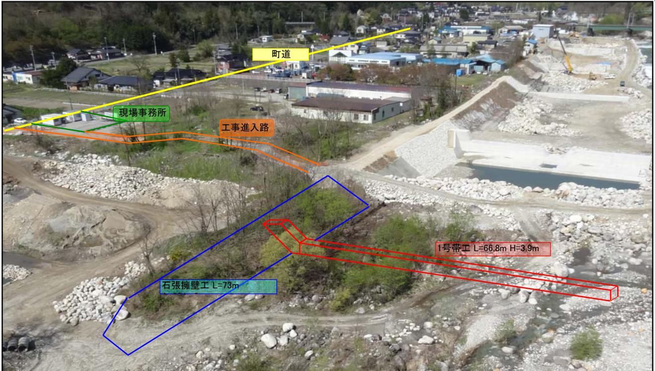
工事概要 ・砂防土工:1式・流路護岸工【石張擁壁工(40cm程の玉石積)】:A=801m<sup>2</sup>・床固工【1号帯工】(河床の土の移動を抑えます)
