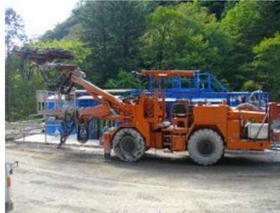
吹付ロボット: 岩盤にコンクリートを吹き付ける重機
