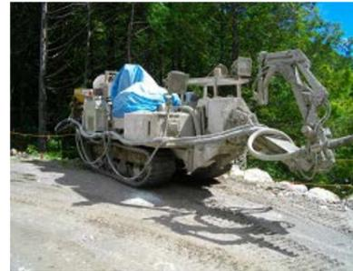
サイドダンプ: 火薬で砕いた岩を外に運び出す重機
