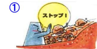
① 上流から流れてくる土砂を溜め込み、下流に流れ出るのを防ぎます。
