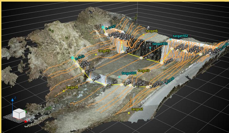
矢立木砂防堰堤補強工事では、大鹿小学校砂防現場見学会でも紹介したドローンにより撮影した写真と測量をして得た座標から3次元データの作成を行いました。3次元データを使用することで土量計算や縦断図、横断図の作成が簡単にできるようになります。
