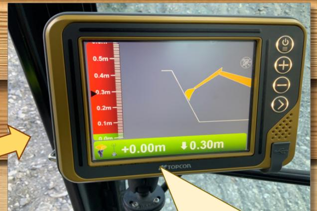
最新鋭の建設機械使用により、現地に「丁張」と呼ばれる掘削の為に目印が不要となります。効率よく作業ができるため、工事現場の週休二日を目指します。
