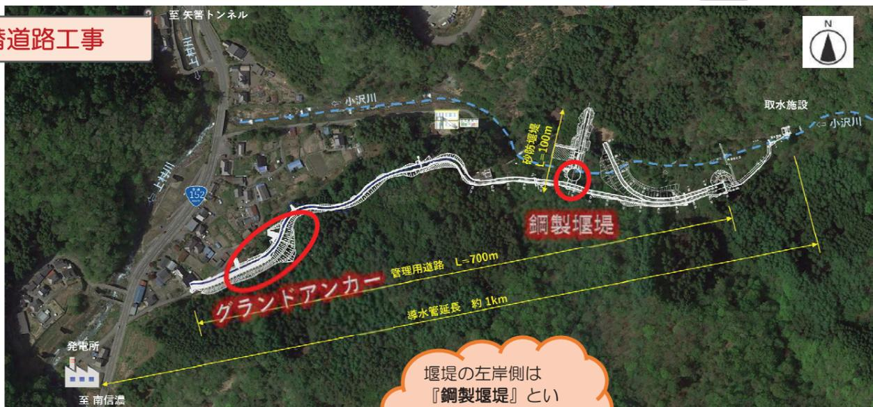
堰堤の左岸側は『鋼製堰堤』というもので、鋼矢板を使って施工しています。
