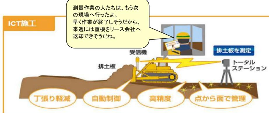
土砂を掘削する場合、従来工法では、丁張 (目印) を設置し、途中で確認の測量を行いながら作業を行っていましたが、建設機械の運転席に設置したモニターに表示される位置情報を見ながらオペレーターが作業を行うことにより、掘削作業の工程が20%程度短縮することができ、また測量に係る人員も60%程度削減することができます。
