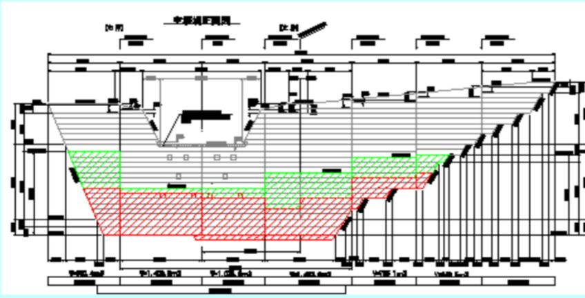
現在工事は残存型枠組立⇒コンクリート打設の繰り返し作業をしております。昨年10月より打設を開始し、1日平均100㎡程打設を行い1月末で3,600㎡程施工しました。寒中のコンクリート打設なので、温度管理を行い、コンクリート品質を低下させないように養生しています。この現場は「旬な現場」として公開しています。興味のある方は見学が可能です。
