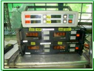
デジタル式反力計、変位計を用いて、橋を傷めないように慎重に持ち上げます。
