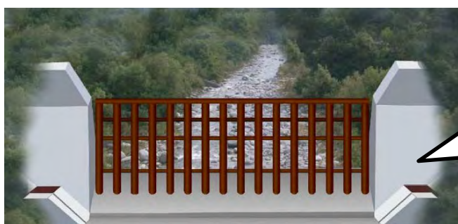
天端と下流面をコンクリートで補修！
