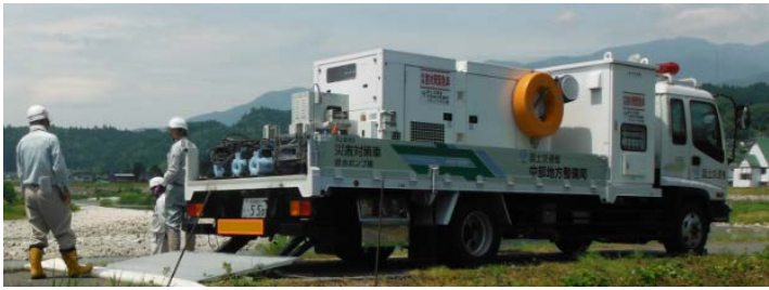
排水ポンプ車
