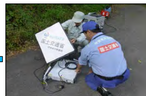
【※Ku-SATによる画像伝送】 ※衛星小型画像伝送装置
