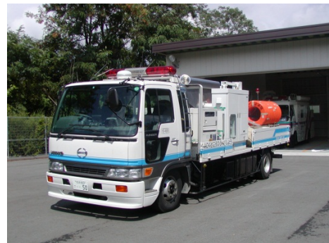
・災害対策車(排水ポンプ車)
