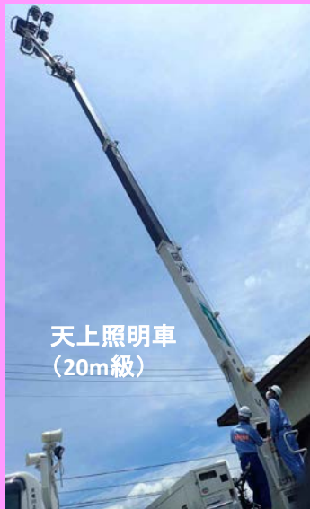
天上照明車(20m級) アウトリガーの操作
