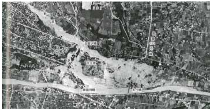
被災直後の野底川下流域の航空写真 白いところが土砂が堆積したところ
