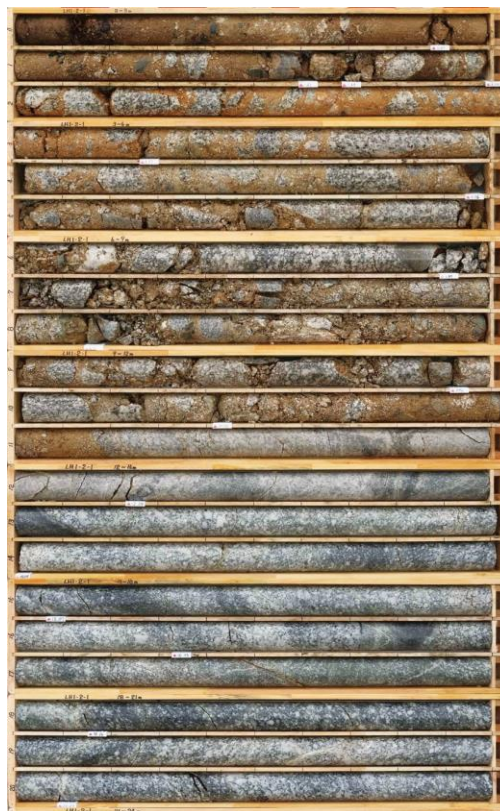
▲ボーリングコア写真
