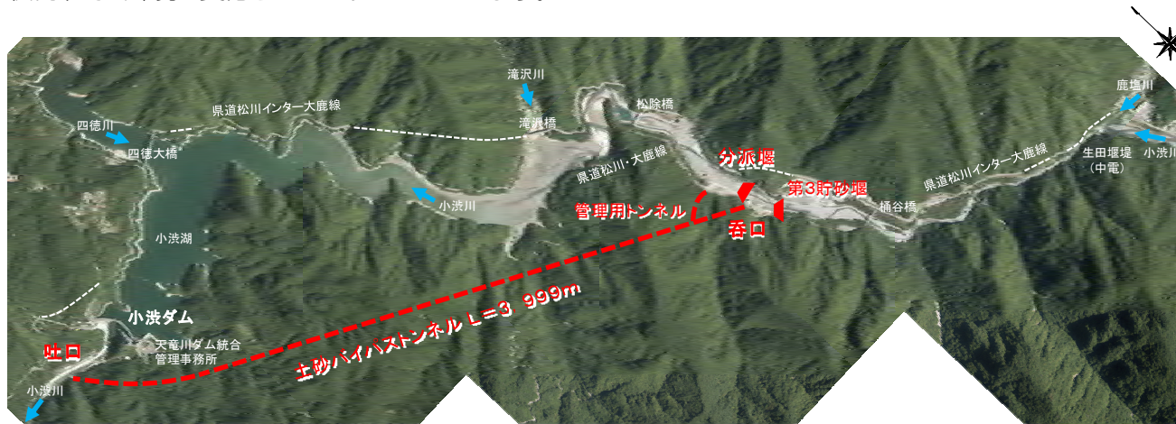
土砂バイパストンネル概要図
